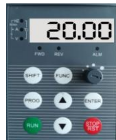
Fig 3-3 Run Status Parameter Display Display Current Output Frequency "20.00"
